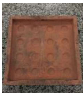
Figura 4. Forma para a fabricação do ladrilho piso tátil.
